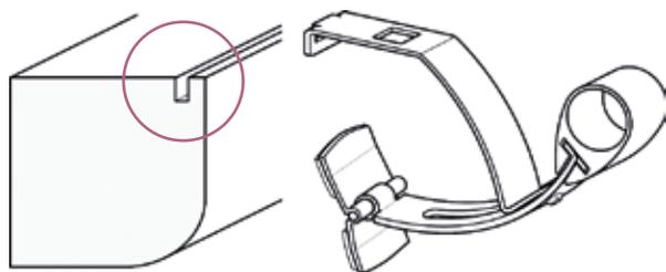
Le coffre de volet roulant présente une rainure en partie supérieure.
