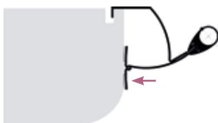
Positionner le support dans la rainure. Puis faire coulisser la platine amovible du support jusqu'à toucher la paroi du coffre et appuyer.
