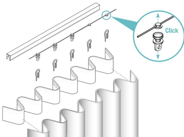
Déclipsés 2 glisseurs en tirant dans le sens opposé (2 morceaux) puis clipser la partie plate de la cordelette sur les glisseurs du conducteur prévu à cette effet.
