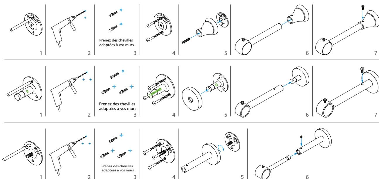
Pour les bâtons Ø 28 et 35 mm, si l'assemblage est réalisé avec un embout à visser, prévoir le montage d'un insert (réf. 175500).
