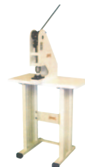
MÉCANISME À SERTIR POUR OEILLET (MÉCANIQUE)
